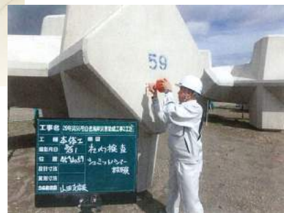
▲社内検査でシュミットハンマー試験
