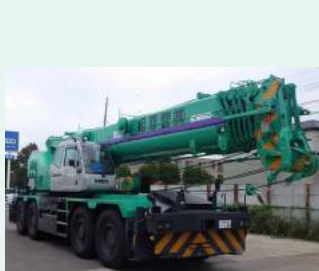
▲70tラフタークレーン
