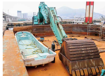
▲約10mの深さまで掘れるバックホウ
