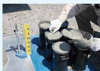
コンクリートが固まった後に行う強度検査用の型に詰める。
