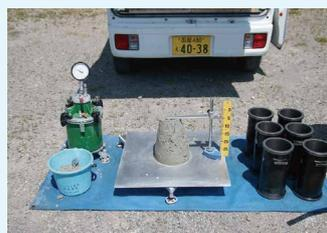
スランプ、空気量、温度、塩化物量が適正か確認します。
