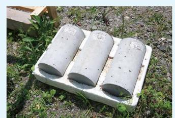
出来上がったサンプル。専用の機械で圧縮し、強度を確認します。
